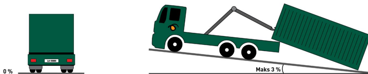
FIGUR 19 ILLUSTRASJON AV MAKSIMALT TVERRFALL OG HELNING I LENGDERETNING FOR RENOVASJONSBIL I HENTESITUASJON.
