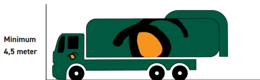
FIGUR 17 ILLUSTRASJON AV HØYDE PÅ BIL VED BRUK AV SNABEL OG NORMALTILSTAND
