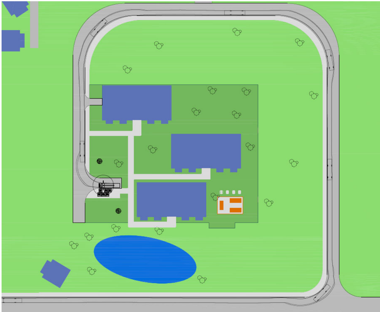
Figur 10: Spøringskurver (L) på utkjøringsvei fra boligområdet for renovasjonsbilen.
